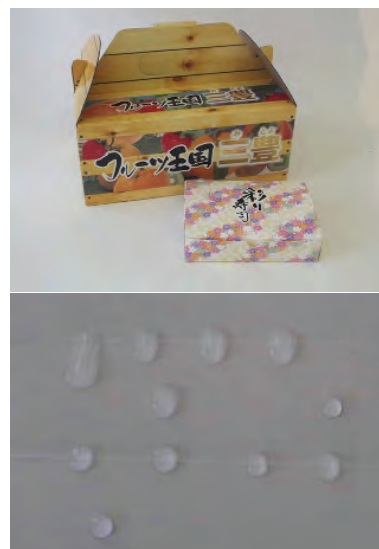
上：撥水・耐油・抗菌処理をした紙製包装箱 下：撥水処理紙が水分を弾いている様子
