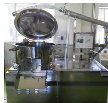
減圧蒸留型抽出装置の構成
