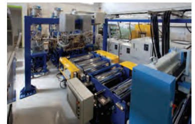
いしかわ次世代産業創造支援センターに設置されたフィルム成形機
