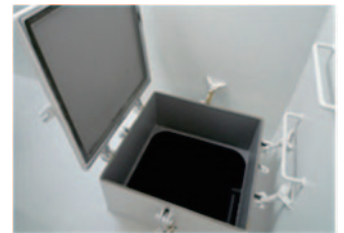
県内造船関連企業で試作した CFRP製小型ハッチ
