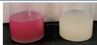
写真 判定液浸漬後の色調の変化 左：アスベスト、右：ロックウール
